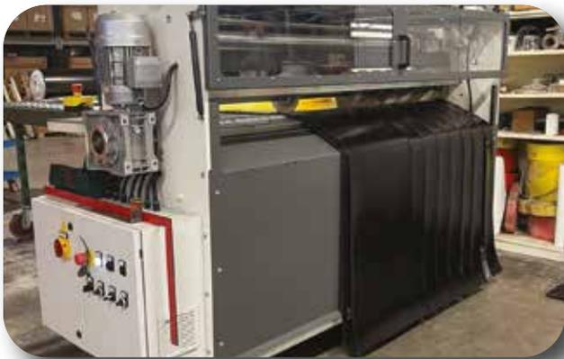
Siamo attrezzati al taglio delle lastre in gomma a striscie e dimensioni a disegno.
